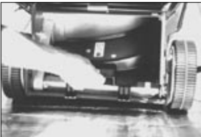
Abb 2 Einbau des Mulchzusatzteils (Modelle 50m, 51m, 60m, 61m und 80m)
